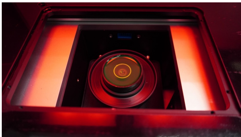
(VAT mounted into build room)
