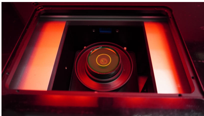
(VAT mounted into build room)
